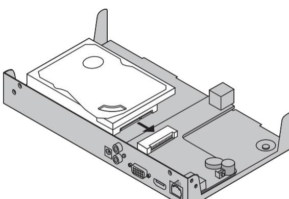
4. NVR을 뒤집어 놓고 HDD 나사를 조입니다. 덮개를 체결하고 NVR의 나사를 조입니다.
