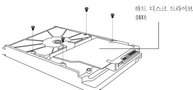
3. HDD의 나사 4 개와 NVR의 구멍 4 개를 맞추고 HDD 인터페이스를 슬롯에 삽입합니다.
